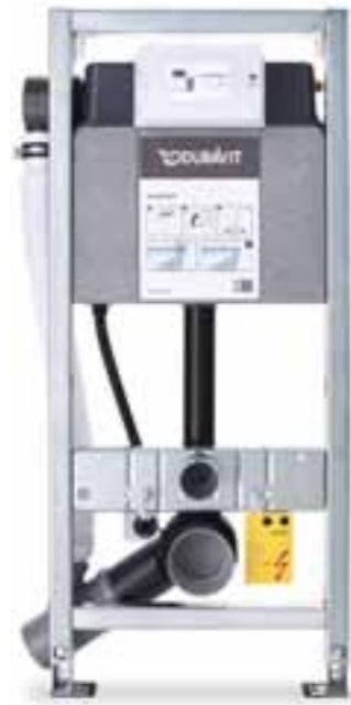
WC-Element mit Geruchsabsaugung manuell # WD1002 000 000 Unterputz-Spülkasten, maximales Spülvolumen 9,0 l, schwitzwassergeämmt, inkl. SensoWash® Vorbereitung. Betätigung von vorne. Geeignet für Trockenbaumontage.
