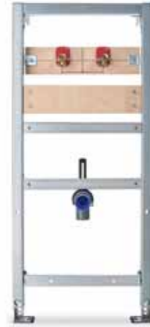
Waschtisch-Element für Wandarmatur # WD2003 000 000 Für Keramik-Waschtische ohne Hahnlochbohrung, Wandarmatur kann mittels Holztraverse montiert werden. Stufenlos höhenverstellbare Traversen.
