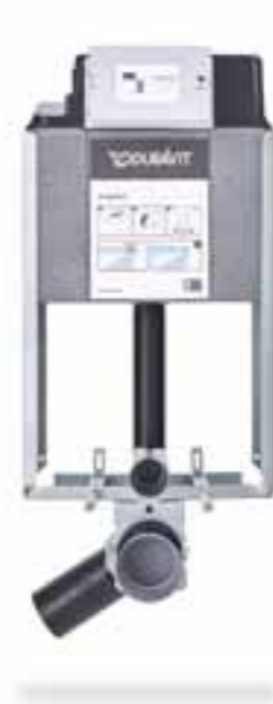
WC-Element für Nasseinbau # WD1005 000 000 Unterputz-Spülkasten, maximales Spülvolumen 9,0 l, schwitzwassergeämmt, Betätigung von vorne. Geeignet für Nasseinbau.
