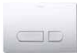
DuraSystem® Betätigungsplatte A1, für WC, Kunststoff Chrom Hochglanz # WD5001 021 000 2-Mengen-Spültechnik, mechanische Betätigung von vorne. Flächenbündiger Einbau in Kombination mit Einbaurahmen möglich (ausgenommen für Nasseinbau).
