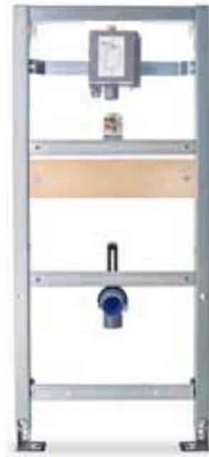
Urinal-Element für Unterputzdruckspüler # WD3002 000 000 Traverse mit Unterputz-Kunststoffgehäuse und Schnellbefestigung. Stufenlos höhenverstellbare Traversen. Geeignet für Trockenbaumontage.
