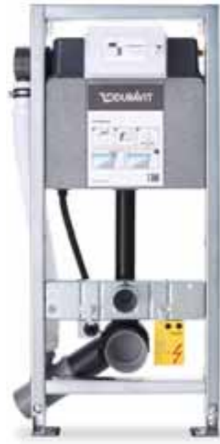
WC-Element mit Hygienespülung und Geruchsabsaugung # WD1004 000 000 Geruchsabsaugung mit integriertem Lüfter, aktivierbar manuell oder automatisch. Rohbauset inkl. UP-Netzteil, Unterputz-Spülkasten, maximales Spülvolumen 9,0 l, schwitzwassergedämmt, inkl. SensoWash® Vorbereitung. Betätigung von vorne. Geeignet für Trockenbaumontage.
