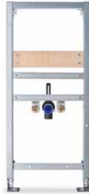
Waschtisch-Element Spezial # WD2002 000 000 Kompatibel mit Duravit Waschtischen, mit abweichenden Befestigungsmaßen: Abstand Eckventile 80 – 290 mm, Stockschraubenabstände 50 – 330 mm, z. B. für Handwaschbecken mit Stockschraubenabstand < 150 mm oder Waschtische mit Standsäule. Befestigungsmaße mittels Holztraverse einstellbar. Stufenlos höhenverstellbare Traversen.
