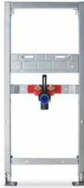
Waschtisch-Element Standard # WD2001 000 000 Kompatibel mit Duravit Waschtischen, mit den Standard-Befestigungsmaßen: Abstand Eckventile 80 – 150 mm, Gewindebolzenabstand 280 mm bzw. 150 – 240 mm im innenliegenden Langloch. Befestigungsmaße über Metalltraverse einstellbar. Stufenlos höhenverstellbare Traversen.
