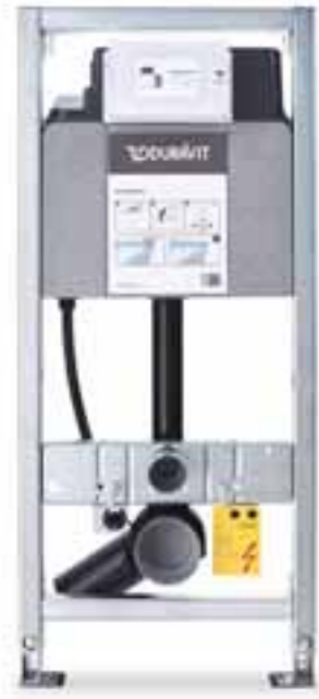
WC-Element mit integrierter Hygienespülung # WD1003 000 000 Rohbauset inkl. UP-Netzteil, Unterputz-Spülkasten, maximales Spülvolumen 9,0 l, schwitzwassergedämmt, inkl. SensoWash® Vorbereitung. Betätigung von vorne. Geeignet für Trockenbaumontage.
