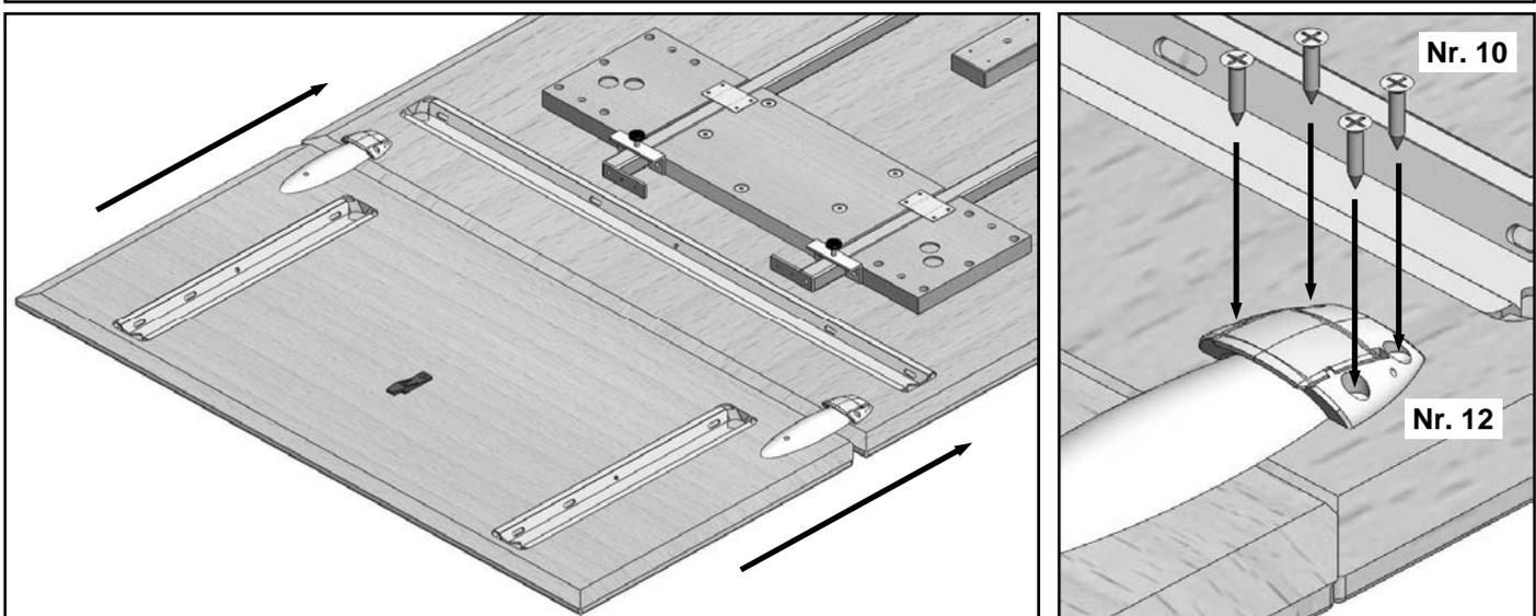
Vormontierten Verbindungsbeschlag an der Ansteckplatte in eine gerade Position drehen, erkennbar durch leichtes Einrasten.
